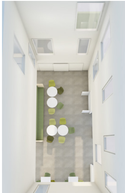
Havainnekuvat 2: A-rakennuksen valokuilu sivulta ja ylhäältäpäin katsottuna. Valokuilu on pinta-alaltaan 39 m 2 . Korkeudeltaan se on 13,4 m, leveydeltään 9,1 m ja syvyydeltään 4,3 m. Tilassa keskitetysti sijoitettu ripustuskoukusto (8 kpl / teoksen kokonaispaino muutama sata kg) ja valaistusvaraus.
